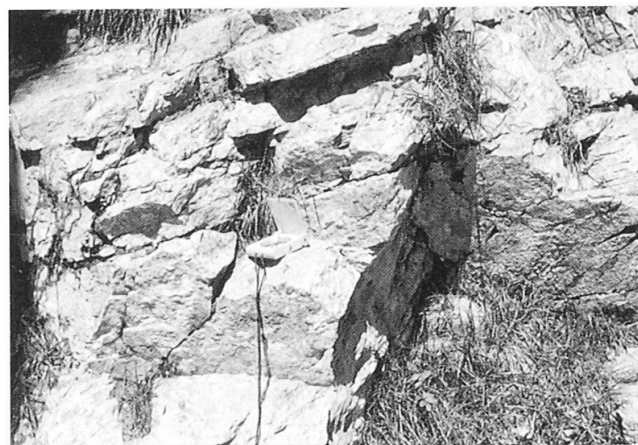
Abb. 5 Klüfte im Öhrlikalk in der Schluchtmitte.
