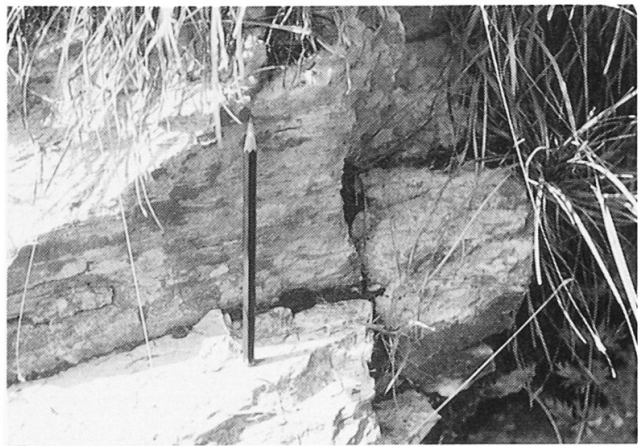
Abb. 4 Klüfte im Tithonkalk am Schluchteingang.
